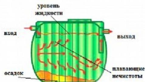
Внутри емкости **GG-1500** смонтирована система перелива, препятствующая выходу осадка и плавающих загрязнений. Емкость комплектуется Кольцом PE KKL-560/600 и крышкой.
