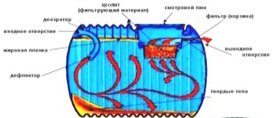
На торцах емкостей установлены два патрубка диаметром 110мм для подключения канализационных труб. Емкости **GG-3000** и **GG-2000** комплектуется крышкой и корзиной для цеолита (фильтрующий материал).
