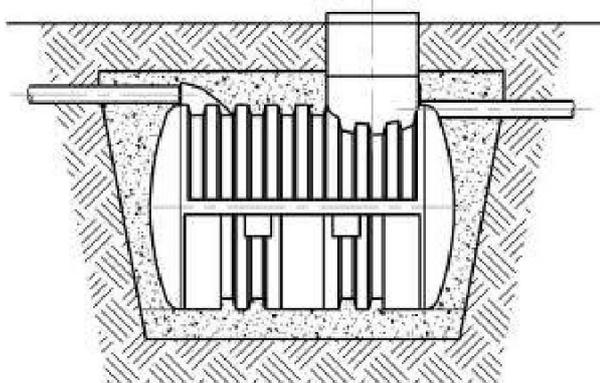
Установка резервуару на глибині більше 0,75м
