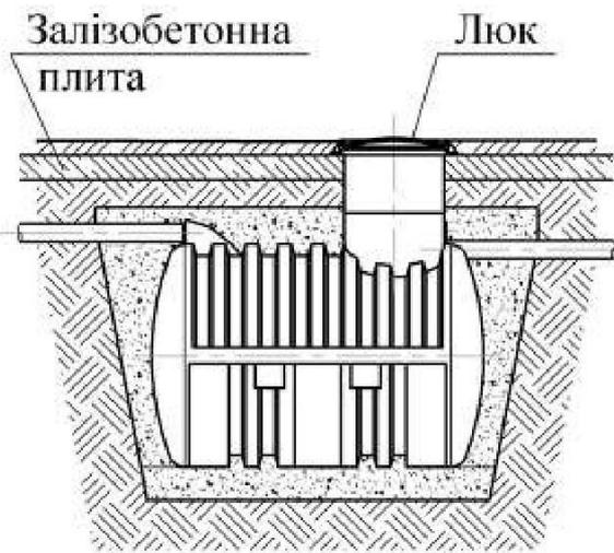
Установка резервуару при високому рівні ґрунтових вод
