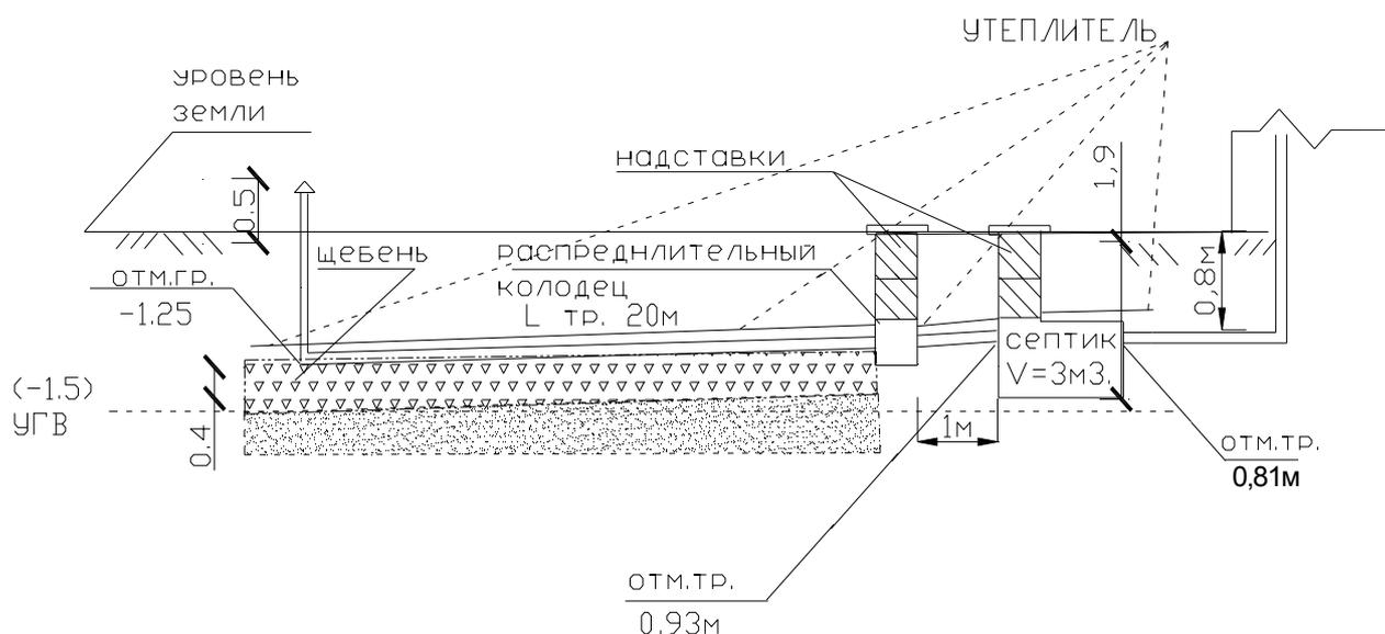
Для нормальной вентиляции септика и дренажа, вокруг септика необходимо смонтировать обводной вентиляционный канал. Под обводным каналом грунт должен быть тщательно утрамбован либо уложен кирпичом, во избежание «провала» обводного канала, а лучше, для страховки подвязать его монтажной стропой и завязать вокруг надставки.
