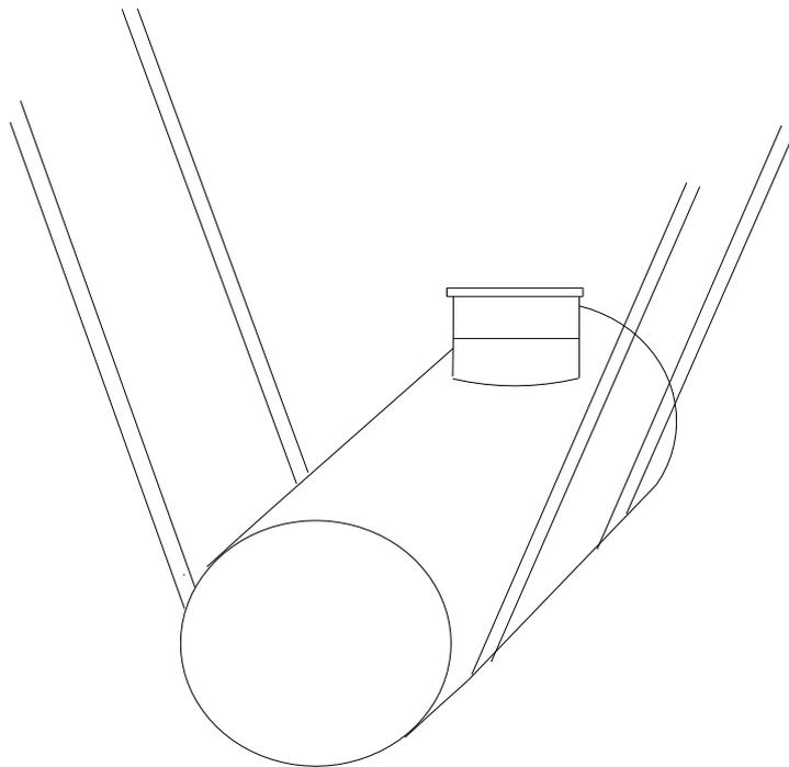
Соединить септик с выходной канализационной трубой из дома, залить его водой. Смонтировать обводной вентиляционный канал и обсыпать септик песком, постоянно проливая песок водой для (хорошей утрамбовки, читай выше!).
