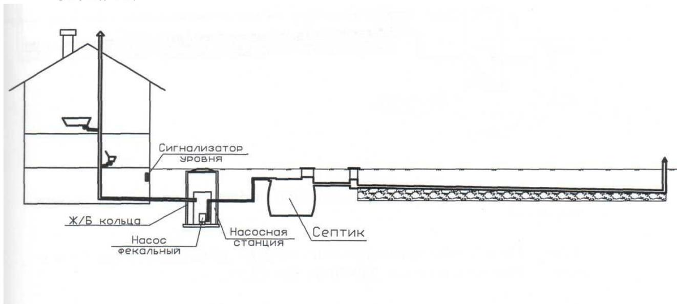
В насосных станциях отлично зарекомендовали себя сравнительно не дорогие итальянские фекальные насосы. В случае аварийной ситуации (в насос попала тряпка) сигнализатор уровня сообщит об этом звуковым сигналом. Необходимо прекратить пользоваться канализацией внутри дома и разобраться в возникшей проблеме.
