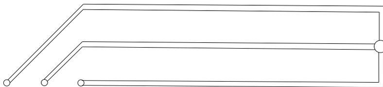
Минимальное расстояние между дренажными ветками 1,5м. Ширина траншеи 0,5-1м. На какую глубину копать траншею? Это определяете после установки распределительного колодца и отвода от него в стороны на 1,5м канализационных труб.
