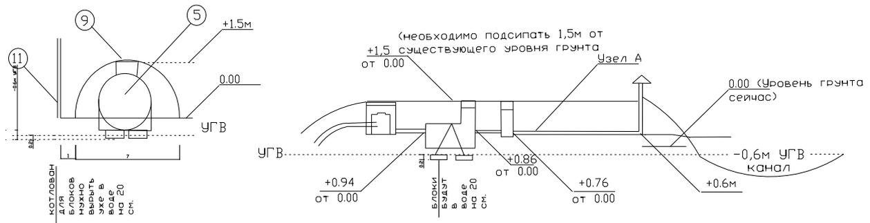
Септик обязательно установить на бетонные блоки и привязать синтетическими монтажными стропами (заякорить).
